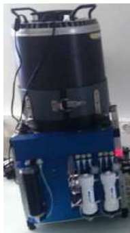
CytoSense (cytomètre autonome in situ ; 1-2500 µm)
