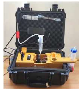
PlanktoScope (microscope en flux frugal; 50-200 µm)
