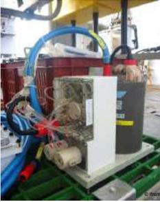
Analyse *in situ* fer, sulfure
