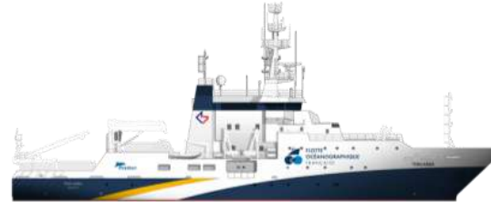
THALASSA Lancement : 1994 Longueur Maxi Total : 23,40 m Maître Bas : 14,70 m Tirant d'eau : 6,20 m Déplacement : 500 t
