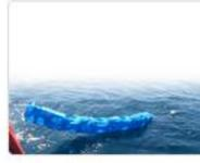
Mesures des bouées dérivantes de surface. Ce système est un mouillage dérivant constitué d'une bouée de surface reliée à une ancre flottante par un câble (orin, câblot). Il doit suivre avec le plus de précision possible la masse d'eau dans laquelle l'ancre flottante est immergée. Les bouées de surface sont suivis par satellites Argos. ...
