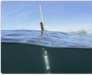
Argo est un ensemble mondial de 3 000 flotteurs à profil dérivant libre qui mesurent la température et la salinité des 2000 premier m de la colonne d'eau. Cela permet, pour la première fois, une surveillance continue de la température, de la salinité et de la vitesse des eaux supérieures, toutes les données étant relayées et rendues publiques dans les ...
