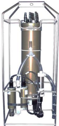
Sonde CTD (T, S, P, turbidité, PAR fluorescence, O 2 )
